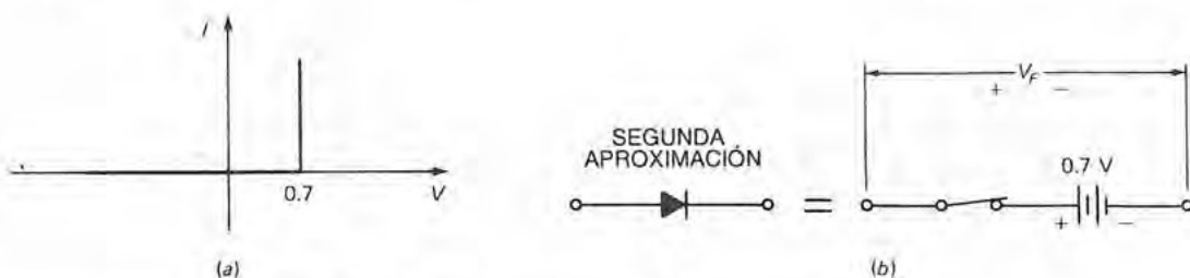
Figura 1-10. Segunda aproximación: a) gráfica; b) circuito equivalente de la polarización directa.
